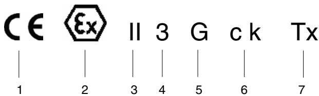
Afb. 15 Markering voor explosiebeveiliging aan de pomp (toestelgroep II, categorie 3)
