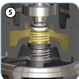
Ölkammer Große Ölkammer für eine lange Standzeit der Gleitringdichtungen
